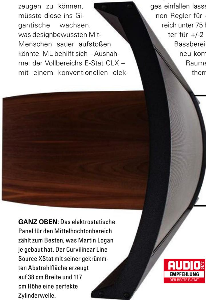
**GANZ OBEN:** Das elektrostatische Panel für den Mittelhochtonbereich zählt zum Besten, was Martin Logan je gebaut hat. Der Curvilinear Line Source XStat mit seiner gekrümmten Abstrahlfläche erzeugt auf 38 cm Breite und 117 cm Höhe eine perfekte Zylinderwelle.
